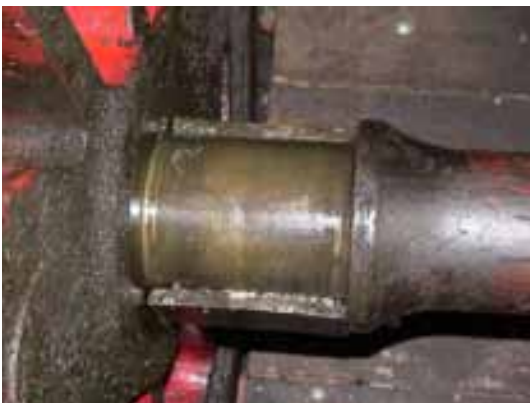
Gegroefde loopvlak met lagerschaal
