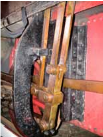
Schaar, met verlengde schuifstang
