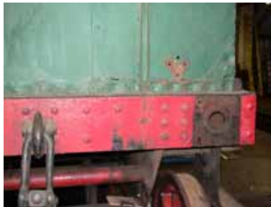
Detail slechte conditie origineel plaatwerk
