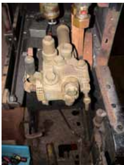
Vacuümejecteur bij de proefplaatsing op de locomotief
