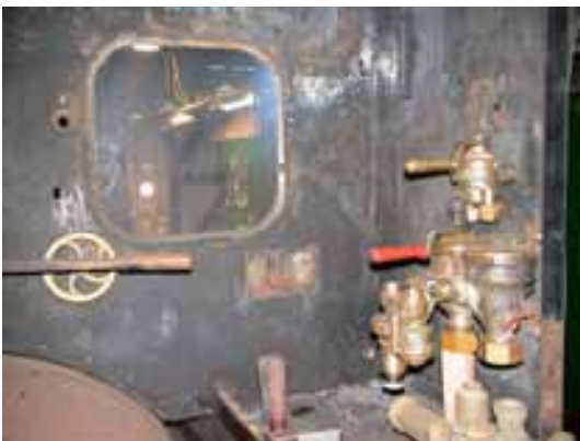
Locremkraan en treinremkraan bij proefplaatsing op locomotief
