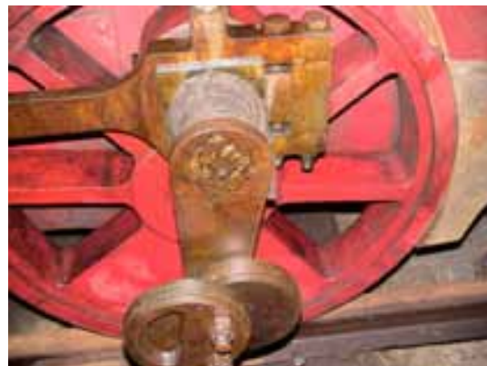
Contrafuk, vast aangebracht op kruktaf
